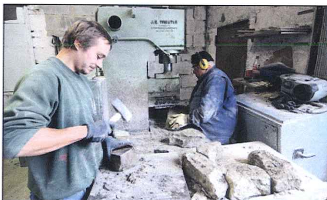
Im Steinbruch Rubenheim findet Wolf & Sofsky das Rohmaterial für den Tavernenbau. Armin Busch (rechts) bearbeitet an der Steinpressmaschine den Kalkstein; links verpasst Richard Flickinger mit dem Hammer den Steinen den letzten Schliff – ein Gesicht, wie er sagt.
